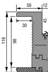
Elargisseur KM1 jusqu'à cloison de 400 mm
